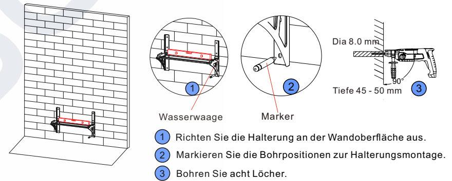
Abbildung 4-9: Bestimmung der Bohrpositionen für die Wandhalterung
