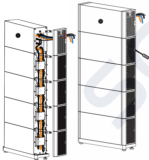
Abbildung 4-65: Montage von Außenkabeln
