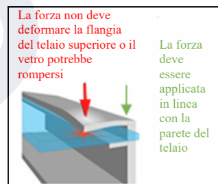
Fig. 1a: posizioni dei morsetti di serraggio
