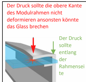
Abbildung 1a: Druck auf die Klemmenstellen
