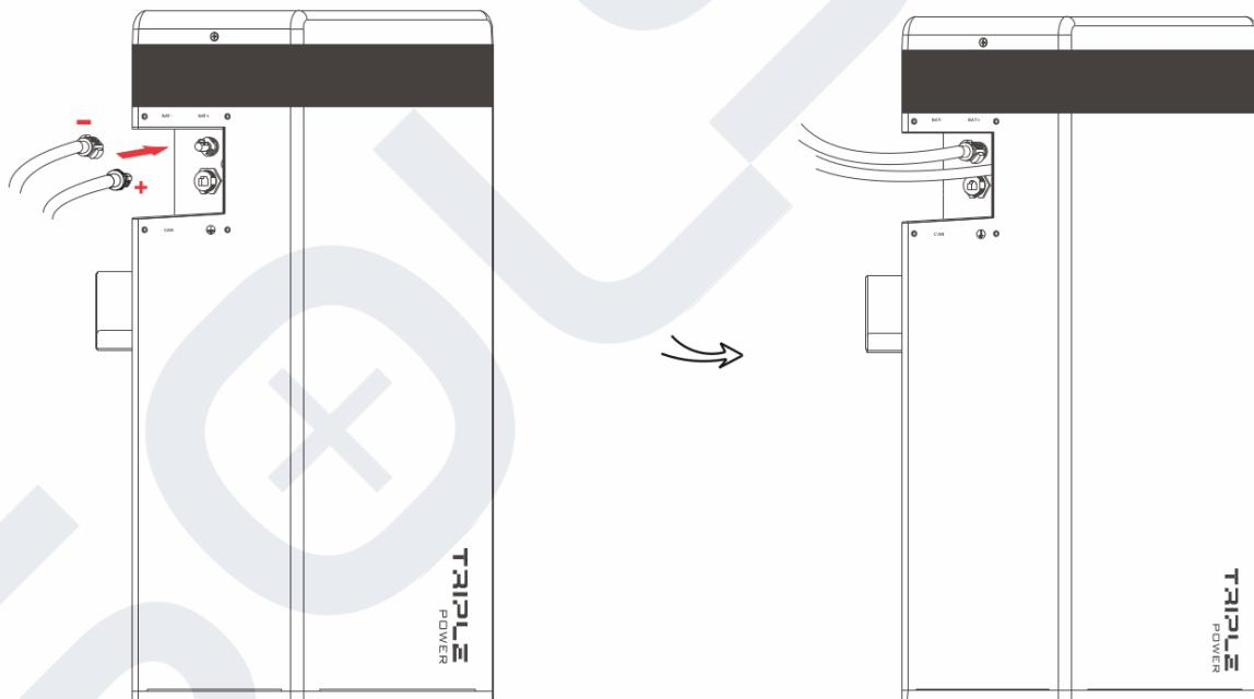
2. Měnič vypněte. Připojte bateriové vodiče se správnou polaritou do příslušných svorkovnic měniče.
