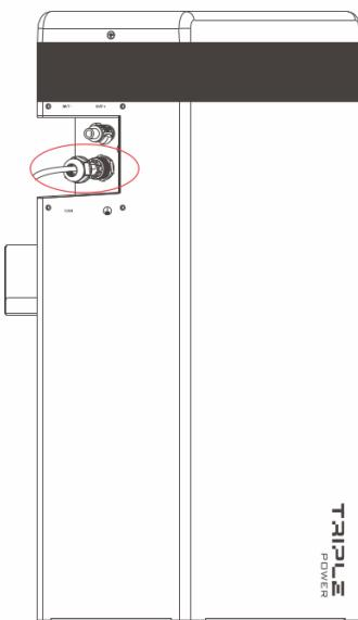
1. Jeden konec komunikačního kabelu CAN (C) zasuňte přímo do konektoru BMS měniče.
